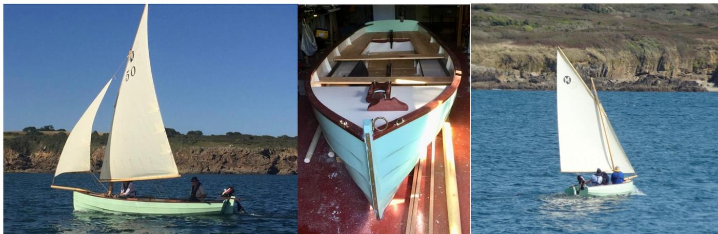
Caractéristiques : longueur : 4,66 m - largeur : 1,56 m - tirant d'eau (dériveur) : 0,25/1,14 m - voilure : 10,6 à 12,5 m<sup>2</sup> - poids : 220 kg - moteur hors-bord : 3 CV - Catégorie et équipage : CS
